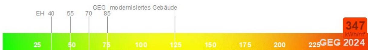
Abbildung 21: Primärenergiebedarf des betrachteten EFH nach DIN V 18599
