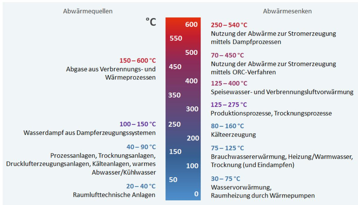
Abbildung 26: mögliche Abwärmequellen und Abwärmesenken (Quelle: DENA, Erfolgreiche Abwärmennutzung im Unternehmen, Darstellung: Österreichische Energieagentur)
