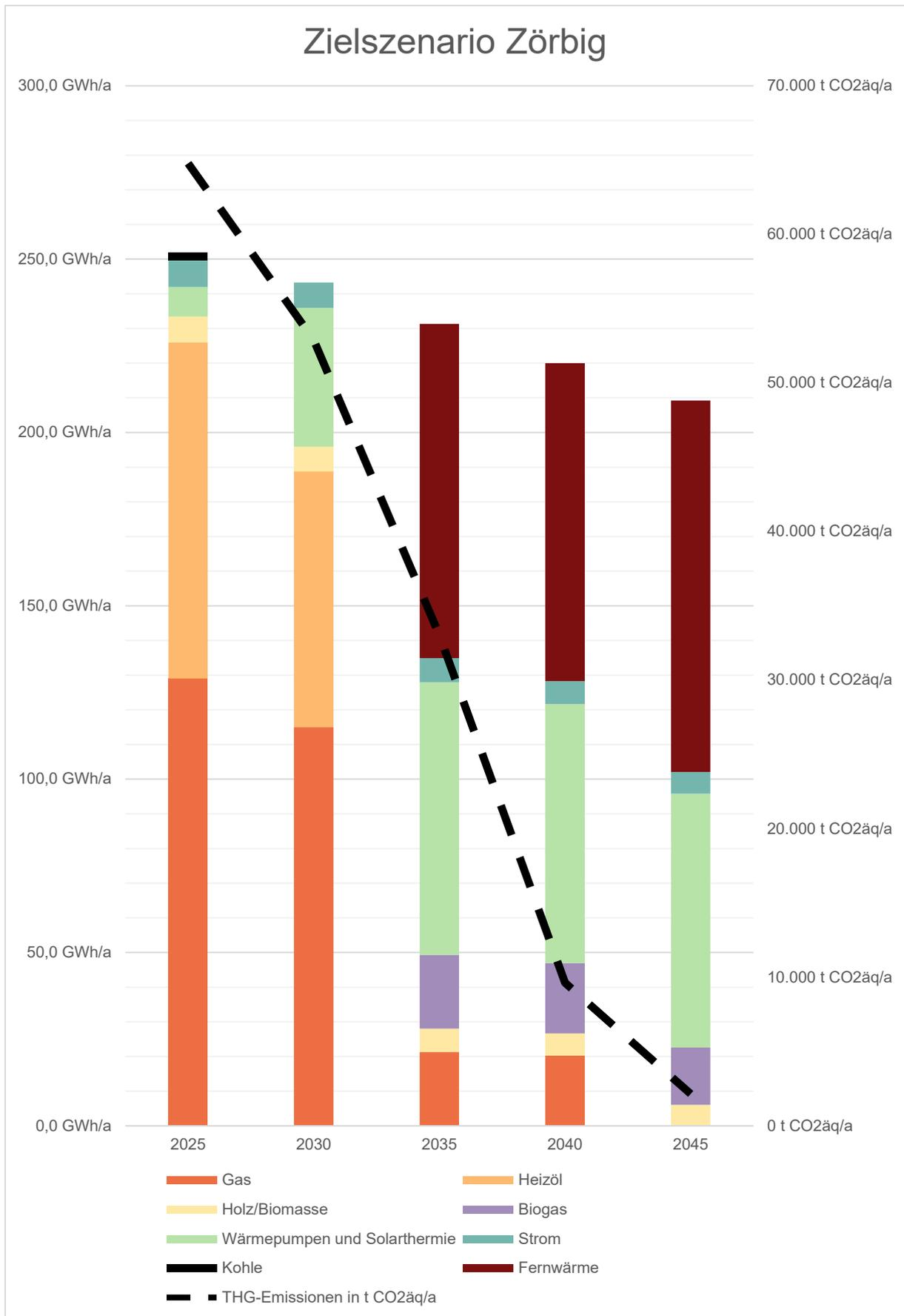
Abbildung 32: Entwicklung der Beheizungsstruktur und der Treibhausgasemissionen im Zielszenario
